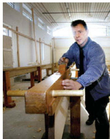
Mats Renström använde sig av en långhyvel för att släta ut kanterna på brädan.
